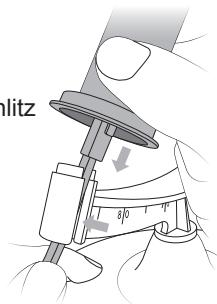
4. Setzen Sie die beiden Halbkugeln zusammen und achten Sie dabei auf den korrekten Übergang am Äquator. Nach dem Einrasten sind beide Halbkugeln fest verbunden. Setzen Sie danach die Blende in die Öffnung am Nordpol.
