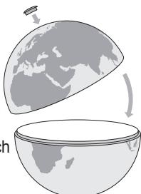
5. Setzen Sie die Kugel seitlich auf die Lampenfassung, ziehen Sie das obere Ende des Meridians leicht nach oben, sodass Sie dieses in die Öffnung der Nordpolblende einsetzen können.
